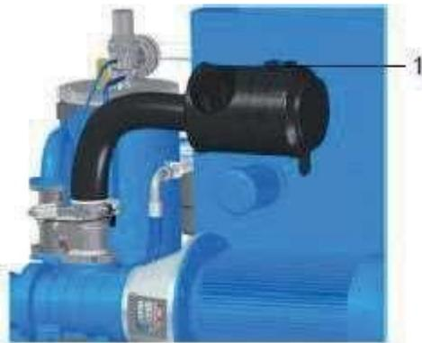
Рис. 41: Расположение воздушного фильтра
