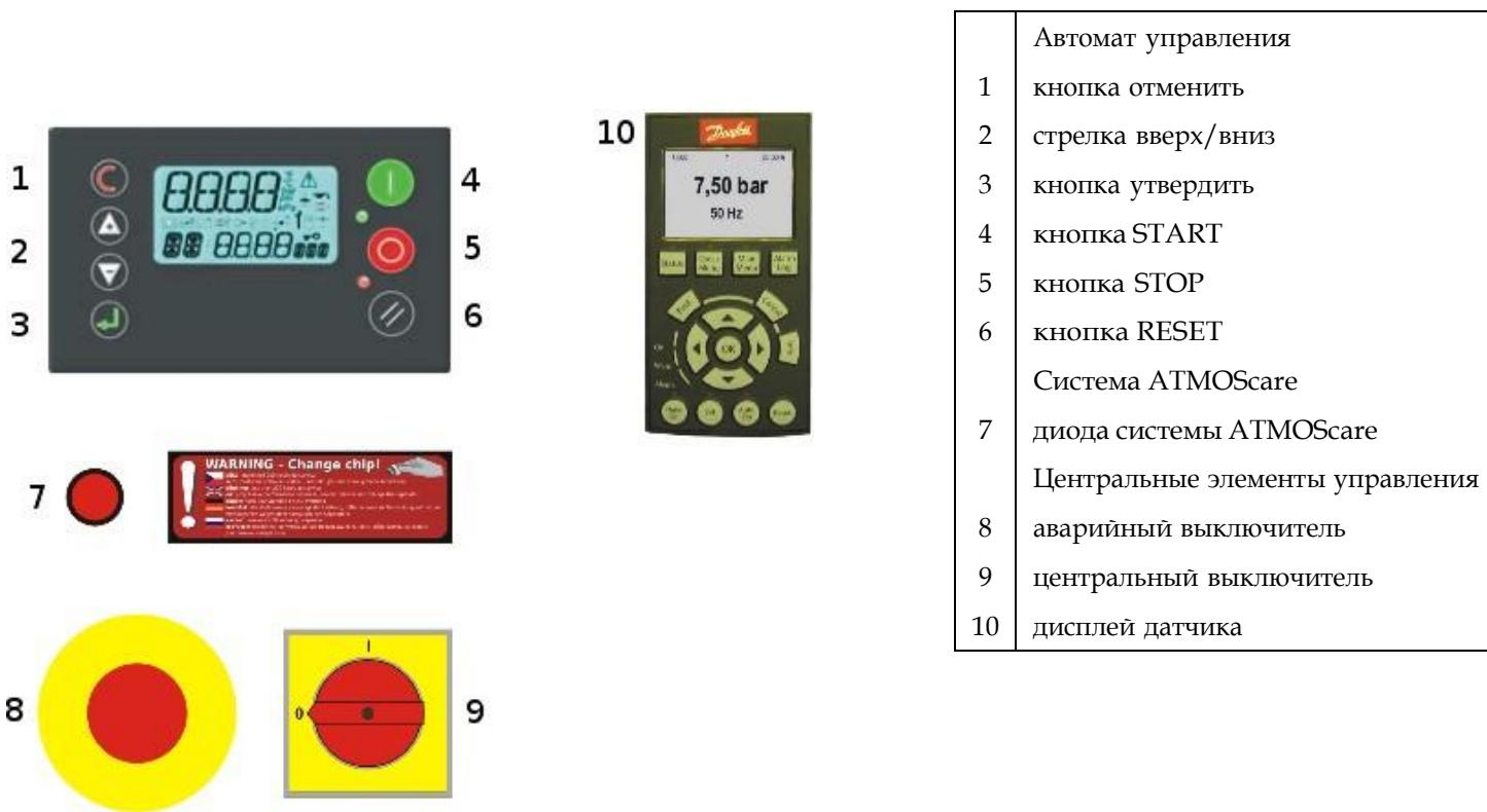
Все функции компрессора управляемы контролером находящимся на передней панели. Кнопками стрелок (вверх и вниз) можно переключать указанные данные на дисплее (температура, рабочие часы и под.). Кнопка RESET используется к аннулировке тревожных входов (если тревога не находится в постоянной активности) и к тому, чтобы вернуться к исходному экрану.
