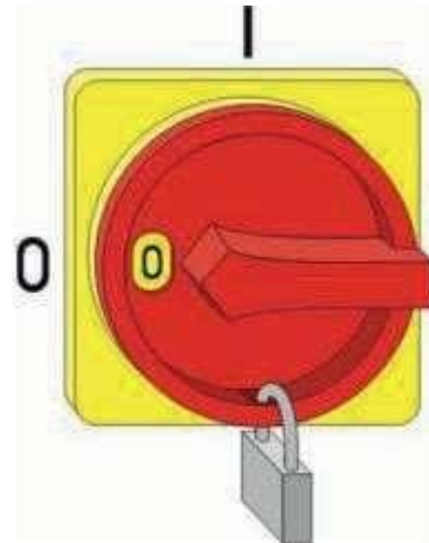
Рис. 26: Фиксация главного выключателя
