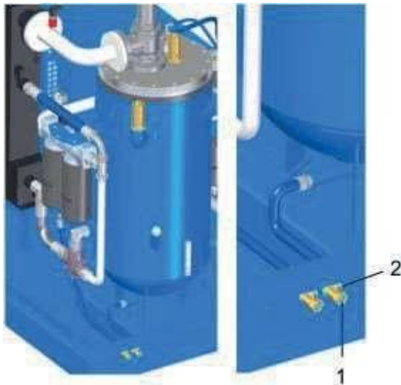
Рис. 40: Отверстие для слива масла
