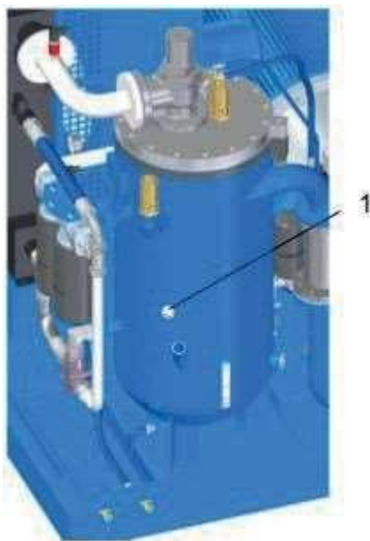
Рис. 38: Пробка наливного отверстия
