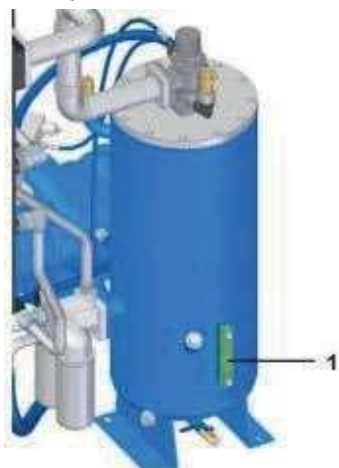
Рис. 31: Проверка уровня компрессорного масла через смотровое стекло
