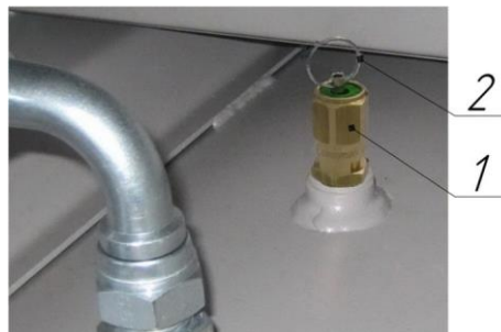
Рисунок 9 – Клапан предохранительный пружинного типа
