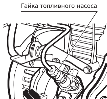
Рис. 16 . Удаление воздуха из топливной системы двигателя
